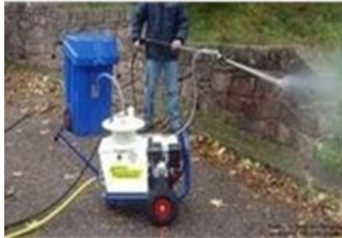
تصویر شماره ۱۷: مخازن سیلیس و آب سیستم سندبلاست تر
